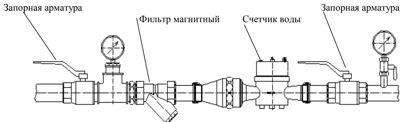
**Пример пломбирования узла учета**
