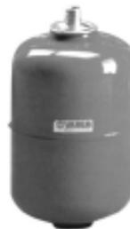
**STARVAREMLR** Емкость цилиндрической, с округлыми краями формы. Мембрана - диафрагменная, SBR-типа, разделяет бак на две части: в верхней находится предварительно закаченный воздух, в нижнюю поступает расширяющаяся вода. Баки этого типа имеют опоры, присоединительный патрубок располагается сбоку. Применяются в системах отопления, кондиционирования, холодильных установках.
