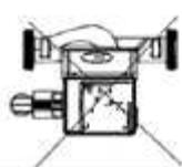
**5.1.** Перед установкой насоса система отопления должна быть промыта.
