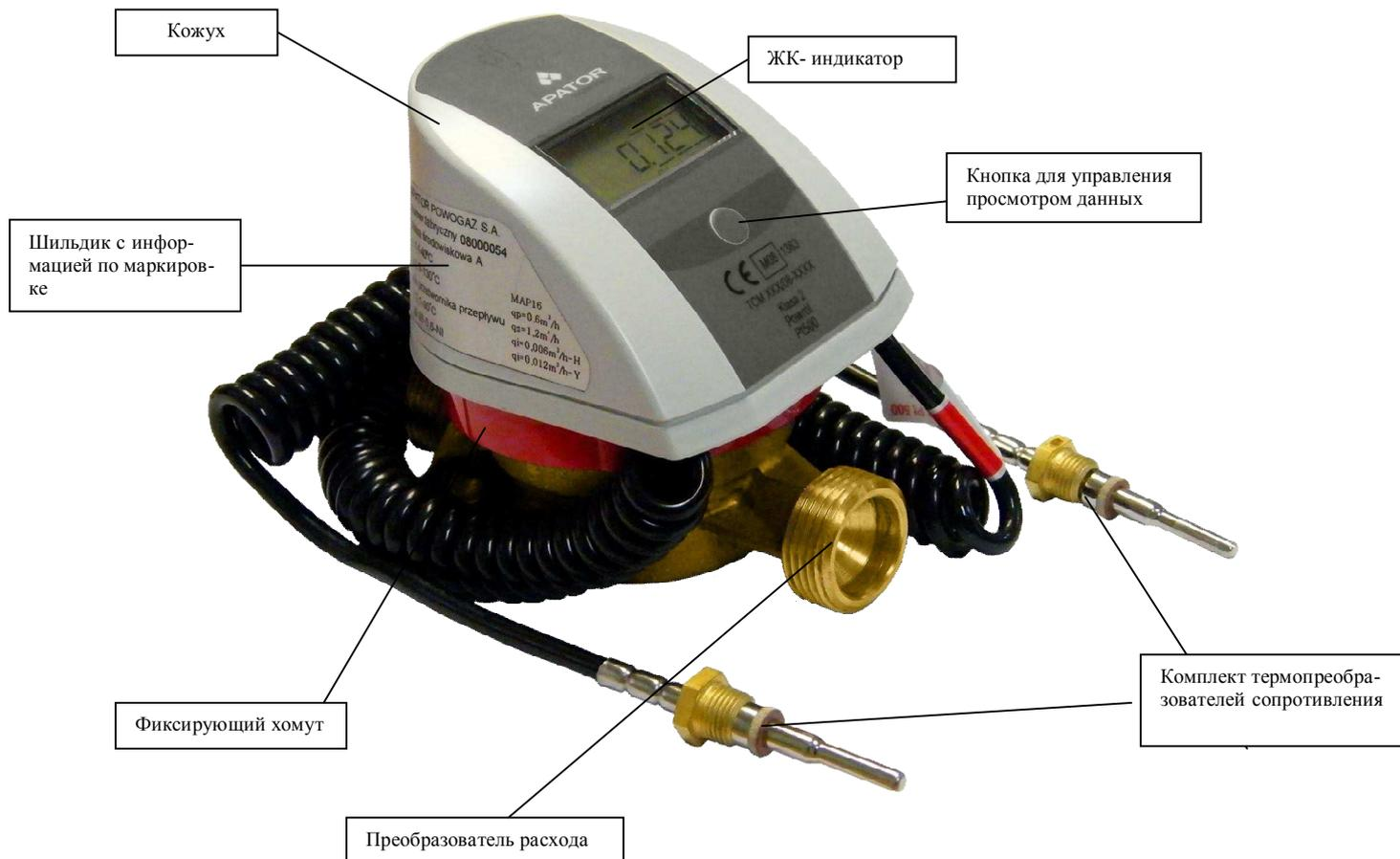
Рисунок 1 Внешний вид и состав теплосчетчика «ELF»
