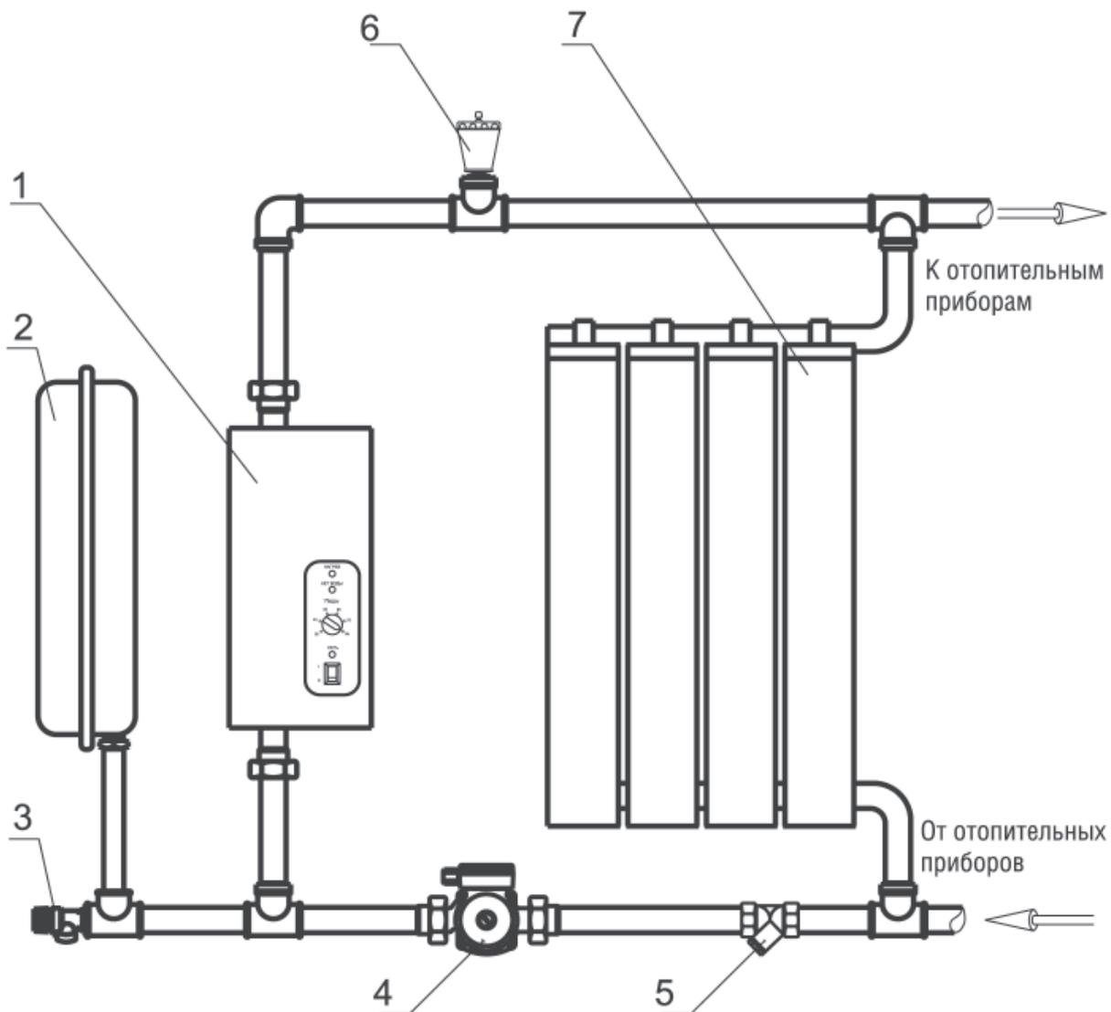
Рис. 2. Рекомендуемая схема подключения отопителя в отопительную систему:
