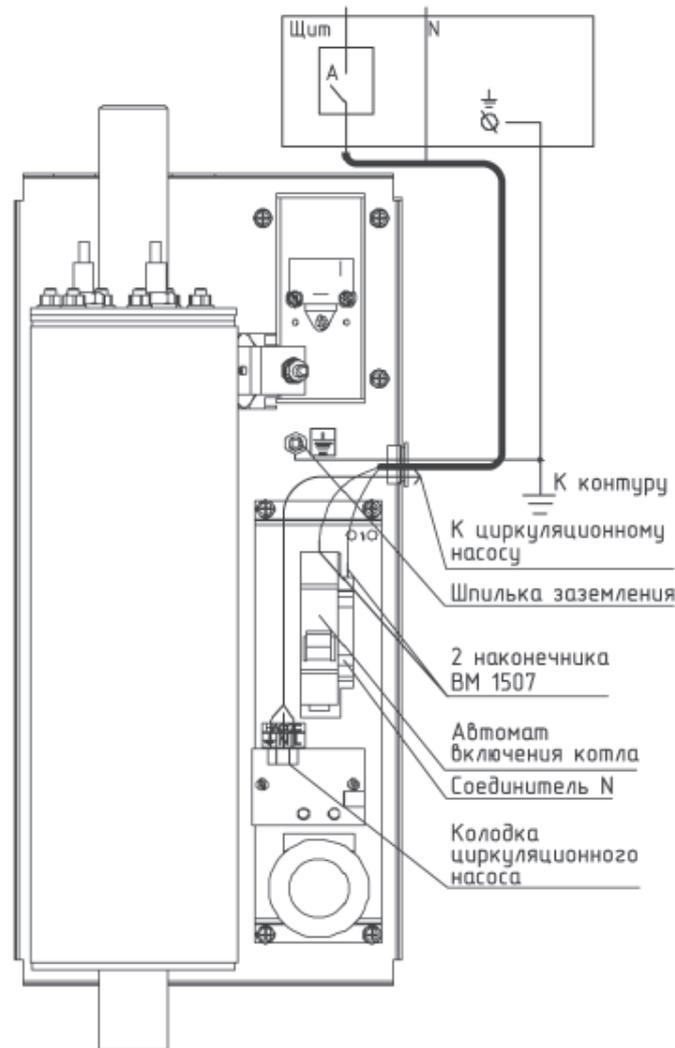
Рис. 3. Подключение отопителя к электрической сети
