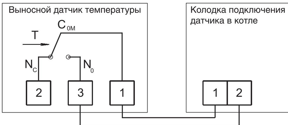
Рис. 4. Схема подключения датчика температуры воздуха
