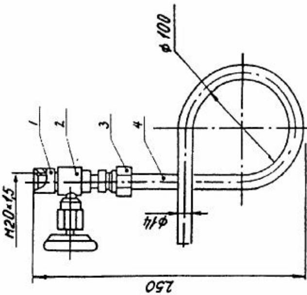
Отборное устройство 016-200-Ст20-МУ предназначено для установки приборов измерения давления на технологических трубопроводах и аппаратах с неагрессивной жидкостью.
