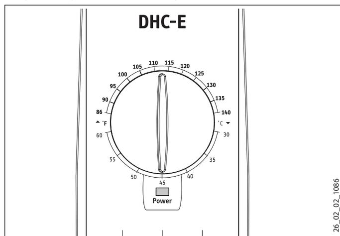
Процесс нагрева воды управляется электроникой. Нагреватель DHC-E может снабжать водой при температурах от 30 °C до 60 °C. Желаемая температура устанавливается ручкой терморегулятора.
