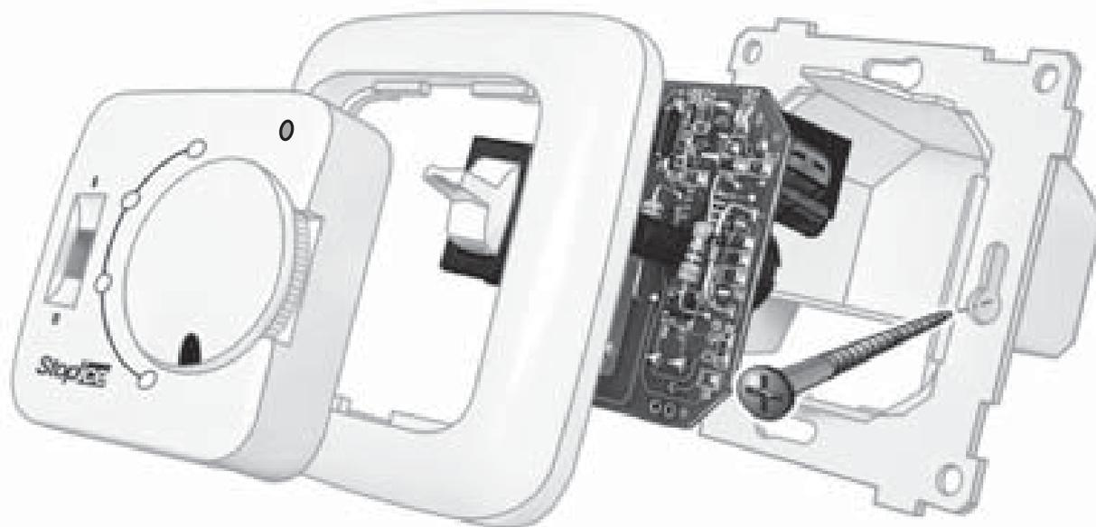
*Рис. 3. Сборка терморегулятора*
