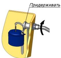
При подсоединении водопроводного шланга к клапану впуска, придерживайте клапан от проворота.
