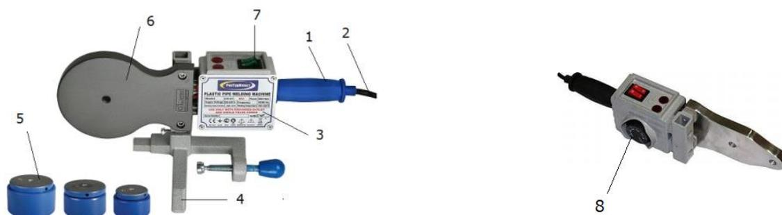
Сварочный аппарат состоит из металлического корпуса (3) и металлической нагревательной панели (6). Металлическая нагревательная панель (6) изготовлена из алюминиевого сплава и имеет антиадгезионное тефлоновое покрытие, которое позволяет производить стыковую (безраструбную) сварку труб.
