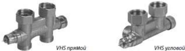
Клапаны регулирующие типа VHS — соединительно-регулирующее устройство для современных радиаторов и полотенцесушителей с нижним расположением соединительных штуцеров при их межосевом расстоянии 50 мм. Не предназначены для контакта с питьевой водой в системах хозяйственно-питьевого водоснабжения.
