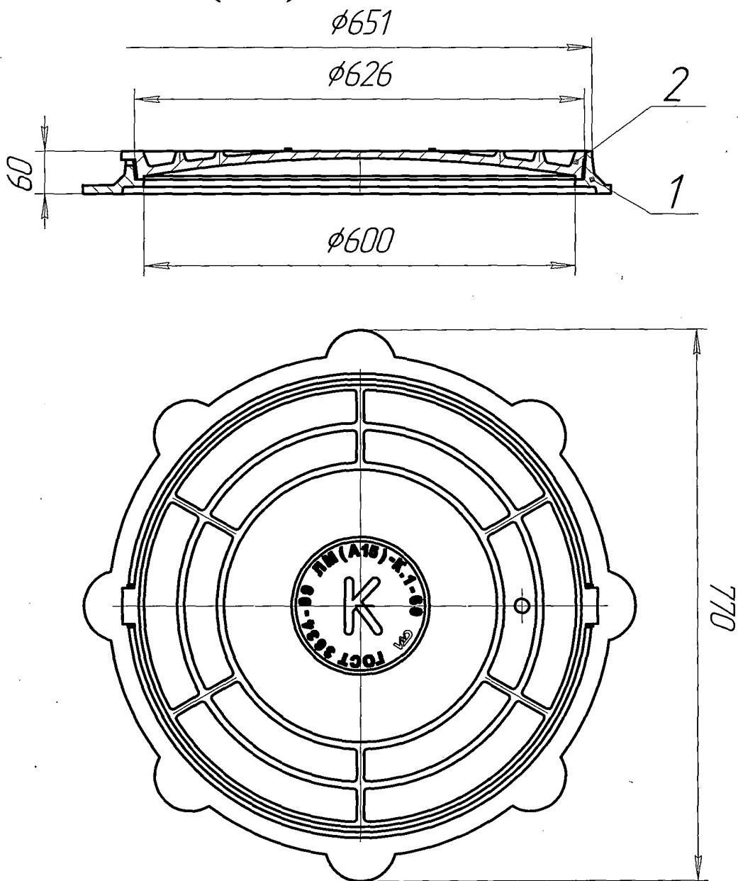
Люк предназначен для установки на смотровые колодцы инженерных городских коммуникаций: тепловых, газовых и кабельных сетей, водопровода, канализации в зоне зеленых насаждений и пешеходных зонах.
