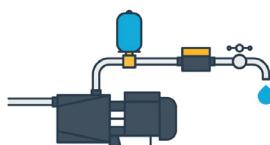
↙ Включает насос при падении давления ниже Pmin или при возникновении потока воды более 2 л/мин (т.е. при открытии крана)
