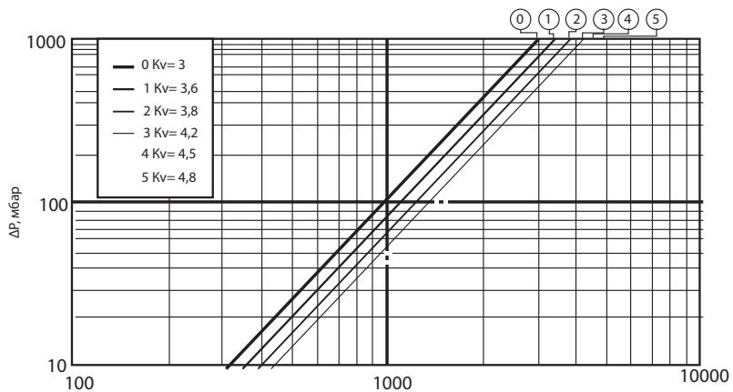
Устанавливая байпас в позицию 0 при расходе 1032 л/ч, получим потерю давления 150 мбар (0,15 бар.). Сопротивление низкотемпературного контура  $\Delta P_{\text{прав}} = 0,25$  бар. Настройка насоса: для обеспечения расхода 1032 л/ч ( $1,03 \text{ м}^3/\text{ч}$ ) и напора  $H = \Delta P_{\text{вн}} + \Delta P_{\text{прав}} = 0,15 + 0,25 = 0,40$  бар (4 м. вод. ст.) установка скорости 2 (рис 4.1 и 4.2).
