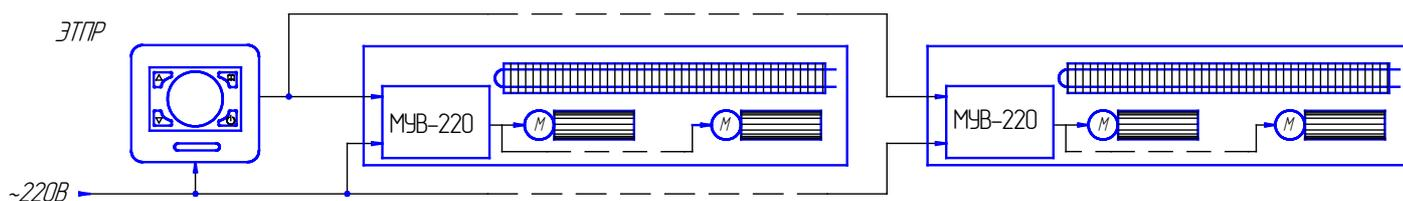
Рис.7 Схема автоматического управления оборотами вентиляторов.
