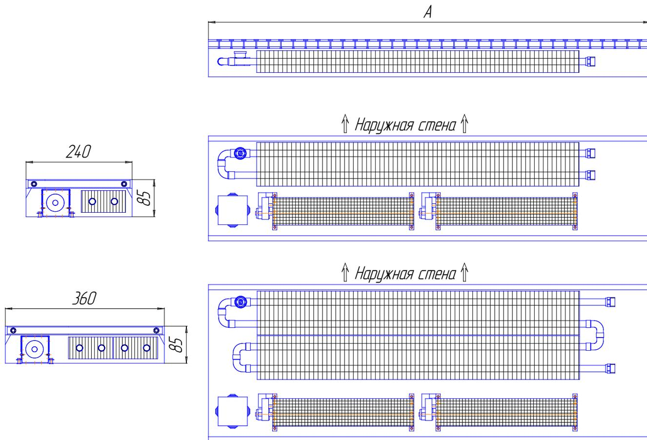
Рис.3 Конвектор «Бриз В» высотой 85мм (принудительная конвекция).
