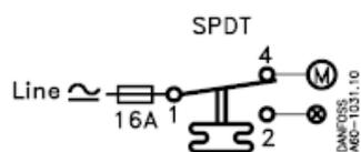
Рис.3.2. Контактная система
