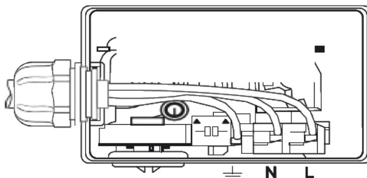
**ВНИМАНИЕ:** Во избежание травм и поражения электрическим током все работы по подключению к сети электропитания, включая устройство заземления, должны проводиться на холодном насосе и при отключенном электропитании. Не допускается соприкосновения силового кабеля с трубопроводом или насосом.
