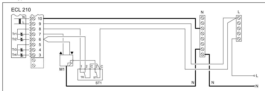
**Подключение датчиков температуры Pt 1000 (для приложений A266.1, A266.2 и A266.9)**
