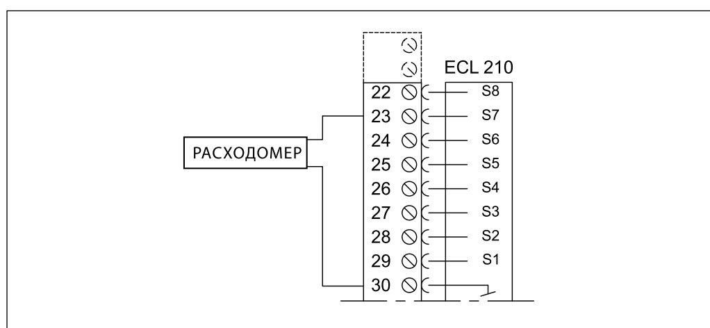
**Подключение датчика потока или кнопки внешней аварийной сигнализации (S8) (для приложения 266.2 или 266.9)**
