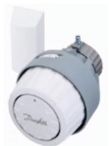
RTR 2922 – термоэлементы с кожухом, защищающим от несанкционированного вмешательства, дистанционным датчиком, защитой от замерзания, диапазоном настройки температуры 5 – 26 °С, устройством для фиксирования и ограничения температурной настройки;
