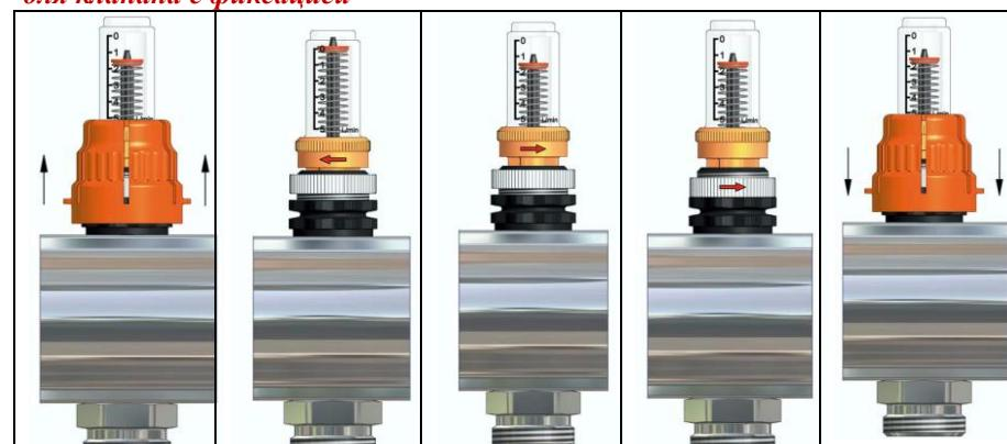
Снять красную защитную гильзу
