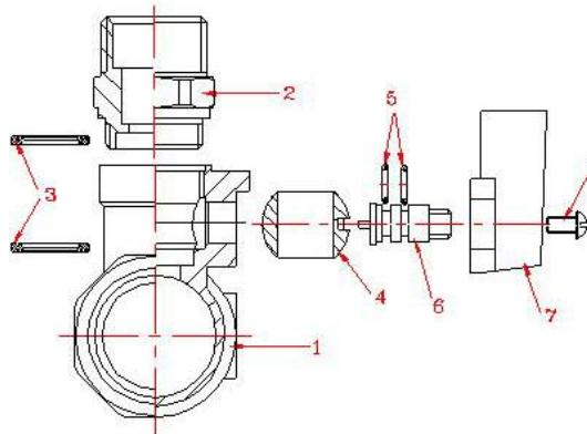
Внутри корпуса между прокладкой из PTFE (трафлана) 3 расположен шаровой латунный хромированный затвор 4. Затвор приводится в движение латунным штоком 6. Уплотнение штока обеспечивается двумя сальниковыми кольцами из EPDM 5. Ручка 7 крепится к штоку с помощью винта 8. Перекрытие потока осуществляется поворотом ручки на 90°. Коллектор поставляется с выходными патрубками, закрытыми защитными пластиковыми колпачками.
