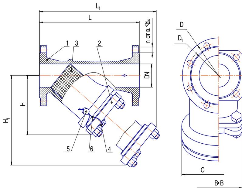
1-корпус; 2-крышка; 3-сетка; 4-пробка для ФСФ; 5-пломба; 6-проволока
