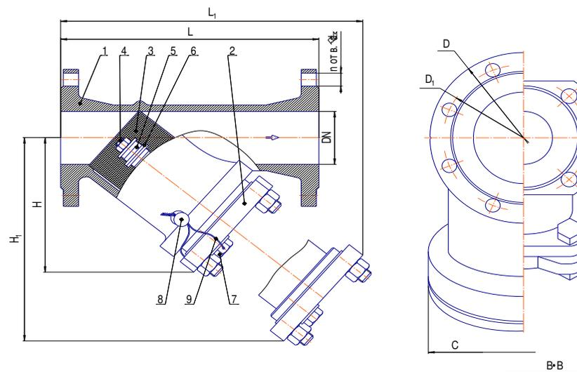
1-корпус; 2-крышка; 3-сетка; 4-стержень; 5-магниты; 6-шайба; 7-пробка для ФМФ;
