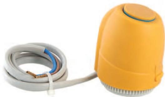
Электротермические сервоприводы предназначены для управления термостатическими клапанами климатических систем по команде комнатного термостата, контроллера или ручного переключателя. Сервоприводы используются совместно с радиаторными термостатическими клапанами (VT.031, VT.032, VT.033, VT.034, VT.035; VT.225K), коллекторными группами VTc.594EMNX, VTc.595EMNX, а также с прочими термостатическими клапанами, имеющими присоединительный размер M30x1,5.
