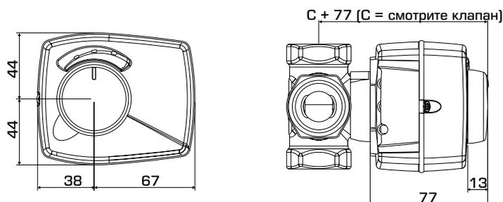
Размеры установки для приводов серии ARA600 со смесительными клапанами ESBE VRG100, VRG200, VRG300 и VRB100
