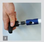
Откалибруйте трубу с помощью подходящей развёртки, удалив оставшуюся стружку.
