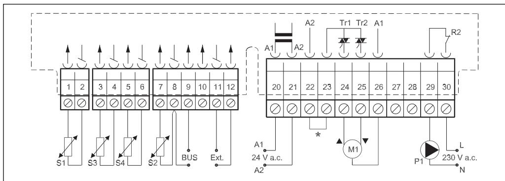
\* Клеммы для предохранительного термостата
