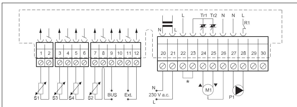
\* Клеммы для предохранительного термостата
