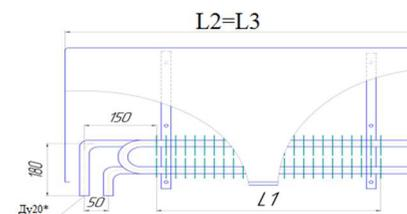
Рис. 2 Конвектор ТЗПО «Универсал НП ТБ-С»
