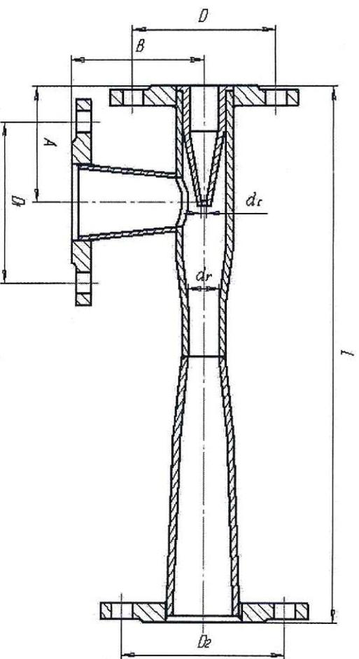
Материал корпуса, диффузора, фланцев и сопла — сталь.
