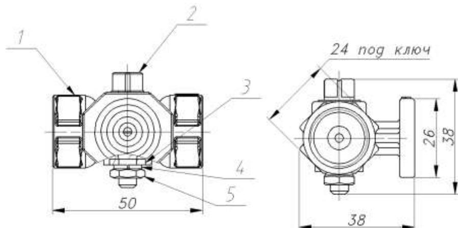
Рис. 1. Конструкция крана.
