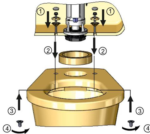
Во избежание течи из-под прокладки 20 (см. рис.1) крепежные гайки-барашки 19 затягивайте равномерно с каждой стороны.
