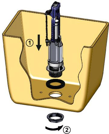
После установки клапана в бачок не допускается касание его подвижных частей клапана впуска и стенок бачка
