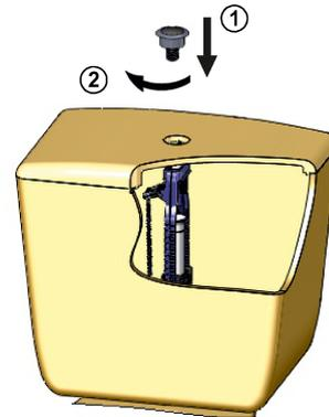
Для надежного центрирования витков резьбы перед ввинчиванием сделать 1 - 2 оборота против часовой стрелки
