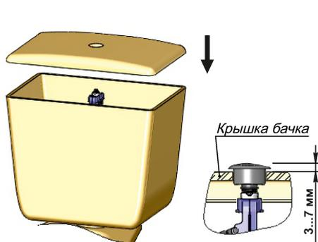
Проверьте чтобы между крышкой бачка и кнопочным узлом, вставленным до упора в резьбу клапана выпуска (не ввинчивая), был зазор 3...7 мм.
