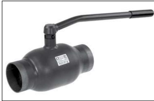
Шаровой кран RJIP Premium DN50–DN150 — двухпозиционная запорная арматура, предназначенная для использования в отопительных и промышленных установках для жидких сред. Класс герметичности А согласно ГОСТ 9544-2015 «Арматура трубопроводная. Нормы герметичности затворов».
