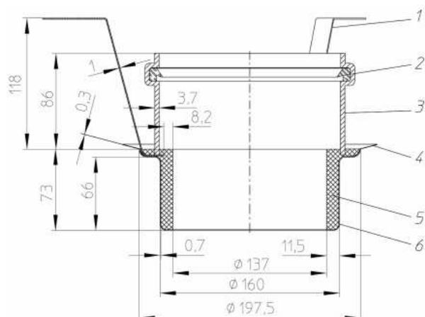
Рис. 7. Противопожарная муфта HL870 для кровельной воронки HL62/1.
