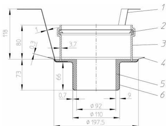
Рис. 6. Противопожарная муфта HL850 для кровельной воронки HL62/7.
