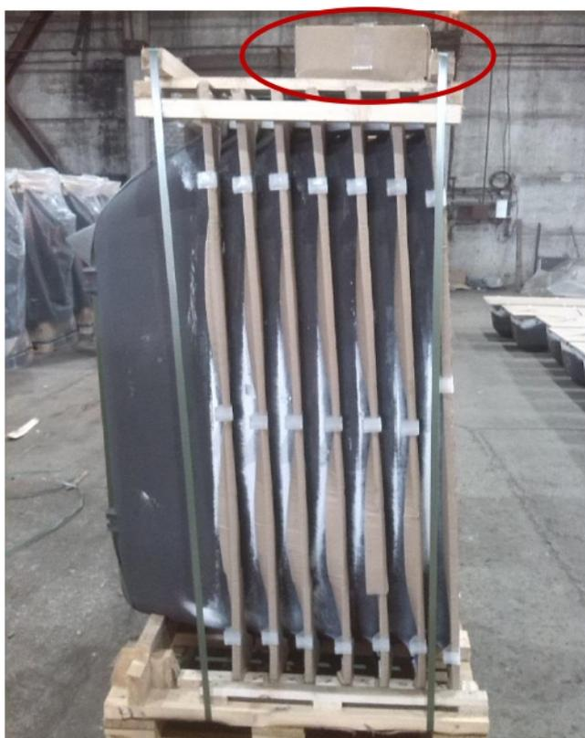
3. Срезать вертикальные поперечные стяжки из полиэстеровой ленты. Снять с пакета упаковочную рамку. Срезать вертикальные продольные стяжки из полиэстеровой ленты.
