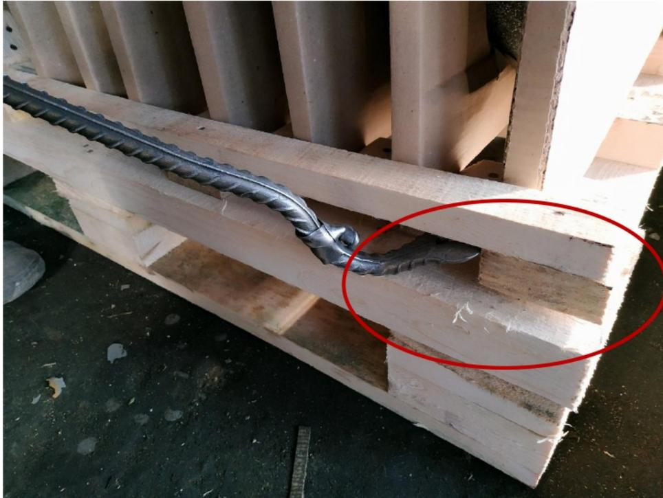
5. При помощи монтировки аккуратно удалить нижние упоры вместе с гвоздями у поперечного борта крайней ванны на паллете. Важно не допускать соударения инструмента с ванной, это может привести к образованию сколов, сдиров и трещин на эмалированной поверхности.
