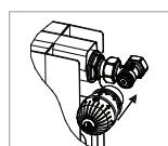
Aggiicare la testa alla valvola Enfoncer la tête sur le robinet Thermostatkopf an das Ventil anbringen. Connect the head to the valve. Установить терморегулятор на клапан поместив выступы на корпусе клапана в соответствующие прорези в основании терморегулятора..
