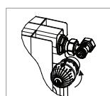
Aprire completamente la testa Ouvrir complètement la tête Thermostatkopf ganz aufdrehen. Open fully the head. Открыть полностью терморегулятор установив ручку в положение полностью открыто.
