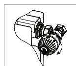
Chiudere completamente la testa. Fermer complètement la tête. Fermer complètement la tête. Close fully the head. Закрыть полностью терморегулятор, установив ручку в положение \*.
