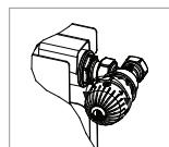
Aprire la testa nella posizione di taratura desiderata. Positionner la tête sur la position désirée. Thermostatkopf so weit aufdrehen, bis er sich in der gewünschten. Open the head into the desired calibration position. Таким образом, терморегулятор установлен на клапане и может быть открыт до нужного положения.
