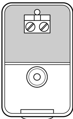
**CZ** Umístěte vnější sondu na severní stranu budovy, do výšky nejméně 2,5 m, tak, aby nebyla vystavena přímému působení slunečních paprsků. Odmontujte víko a nainstalujte sondu s použitím kotvy a šroubu z příslušenství. Proveďte zapojení s použitím kabelu 2x0,5 mm<sup>2</sup>. Maximální délka spojovacího vedení je 50 m. Po navrtání příslušného průchodu vložte kabel ze spodní části dovnitř a připojte jej ke svorce. Vraťte víko sondy zpět na původní místo.
