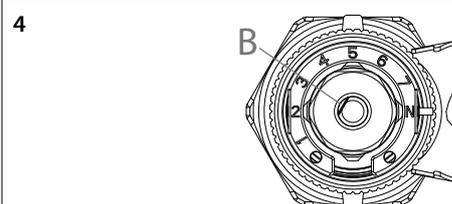
Удалите ключ по окончании настройки, шток "B" будет находиться в нужном положении предварительной настройки, отмеченной символом на настроечной шкале клапана. Позиции регулировки 1, 2, 3, 4, 5, 6, 7, N (N – клапан полностью открыт).
