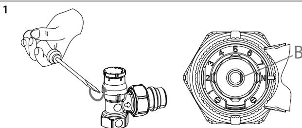
Для доступа к шкале настройки удалите красный защитный колпачок с помощью отвертки. Обозначение "N" на шкале, расположенное напротив риски "B" соответствует полному открытию клапана.
