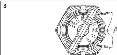
Установите ключ для настройки и поворотом выберете требуемое положение, соответствующее расчетному расходу, совмещением с меткой (позиция "A") на корпусе клапана.
