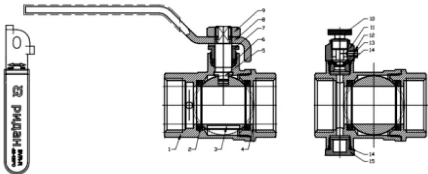
Рис.1 Конструкция шарового крана DN 15-50 мм
