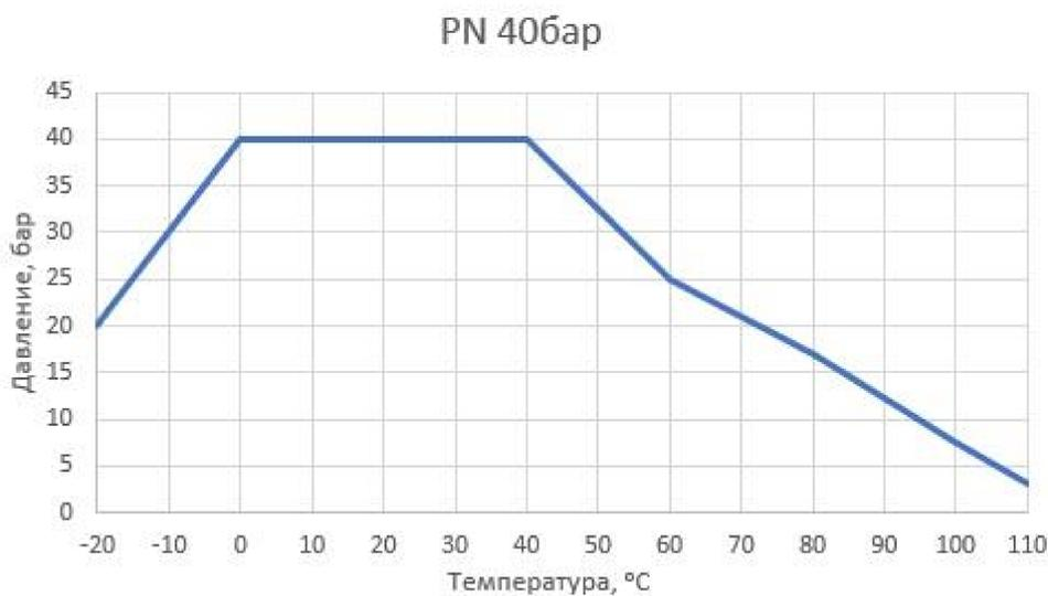
рис.1: Зависимость рабочего давления от температуры перемещаемой среды
