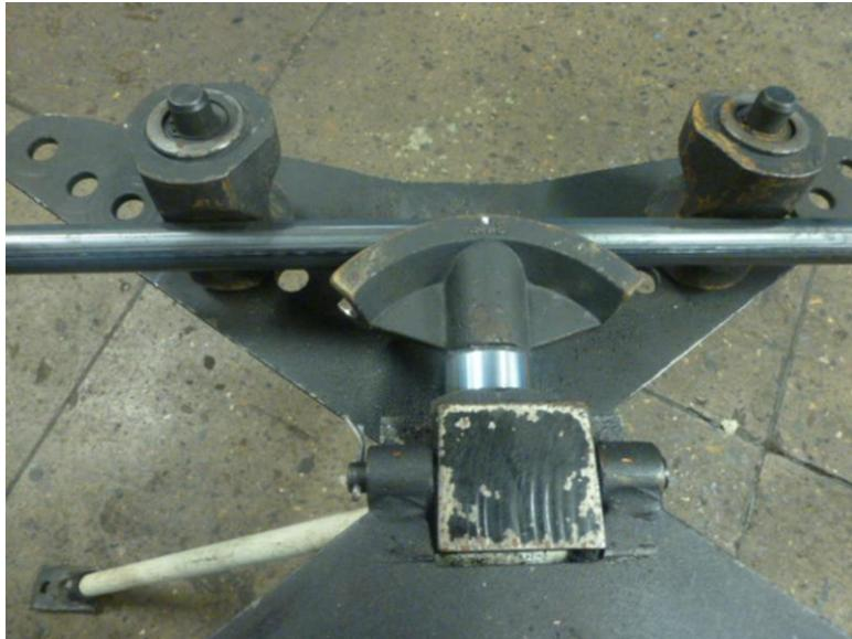
Труба устанавливается в соответствии с ГОСТ 3728. Сварной шов в зоне сжатия под углом 45° к плоскости загиба. Используется стандартный сектор 3/4 дюйма, упорные ролики устанавливаются в соответствующие отверстия станины.
