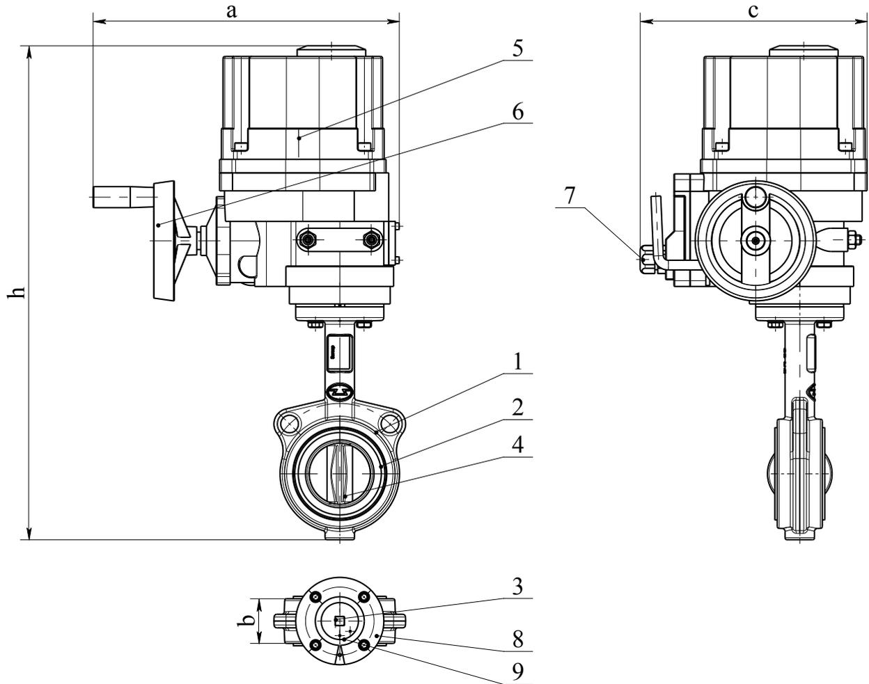
1 – Корпус затвора; 2 – Манжета; 3 – Шток; 4 – Диск; 5– Электромеханический привод; 6 – Маховик; 7 – Гермовводы, 8 – Проставка; 9 – Шайба поворотная.
