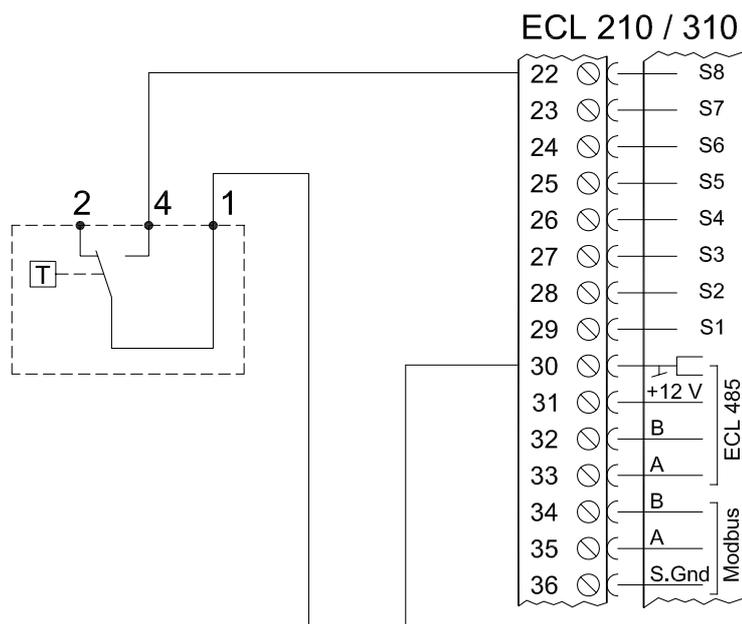
При срабатывании датчика пожара контакты 1–2 размыкаются.
