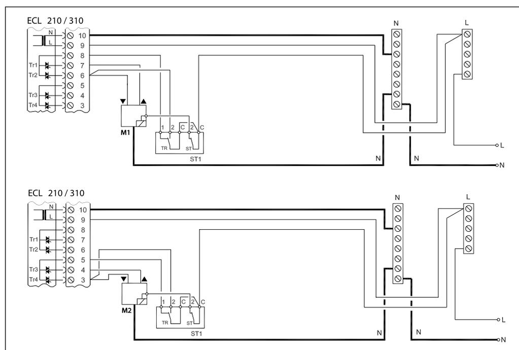
Неправильное подключение внешнего оборудования и питания может привести к повреждению регулятора. Сечение проводов силовых цепей — 0,5–1,5 мм<sup>2</sup>.
