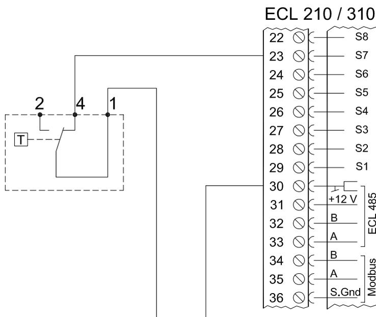
**Подключение датчика пожарной безопасности S8**
