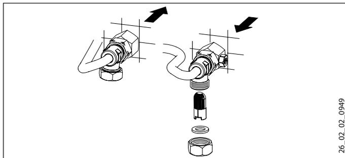
Очистить сетчатый фильтр в резьбовом соединении трубопровода холодной воды. Закрывать запорный вентиль в трубопроводе подачи холодной воды, демонтировать сетчатый фильтр, очистить его и установить снова.
