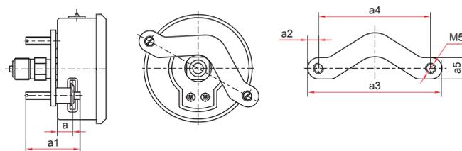
Осевое присоединение со скобой тип 2 (Ø63 мм)
