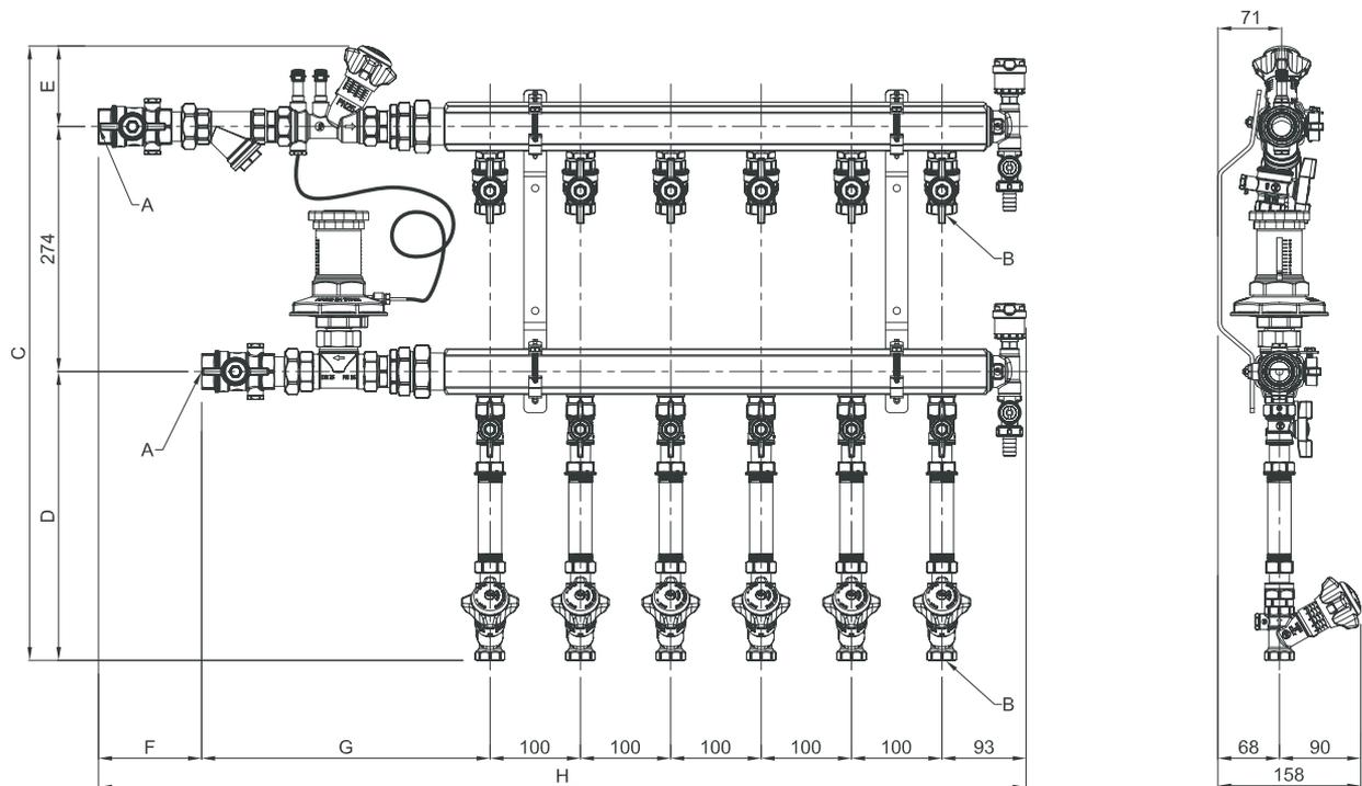
диаметр коллекторной планки DN32
