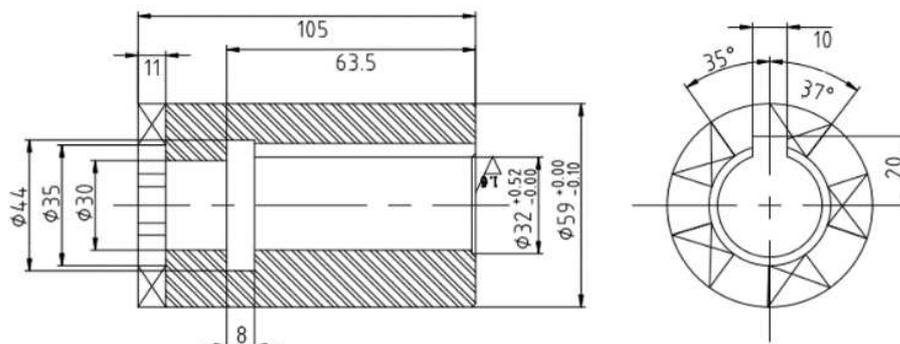
Рис. 1. Геометрические характеристики переходника ISO F14×OCT Б.
