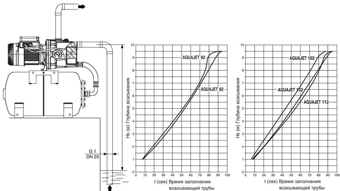
Гидравлические характеристики получены для жидкости с кинематической вязкостью 1 мм<sup>2</sup>/с и плотностью 1000 кг/м<sup>3</sup>. Допуски гидравлической характеристики соответствуют ISO 9906.
