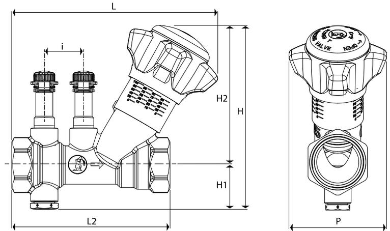
**Таблица 2. Размеры балансировочных статичных клапанов R206B**
