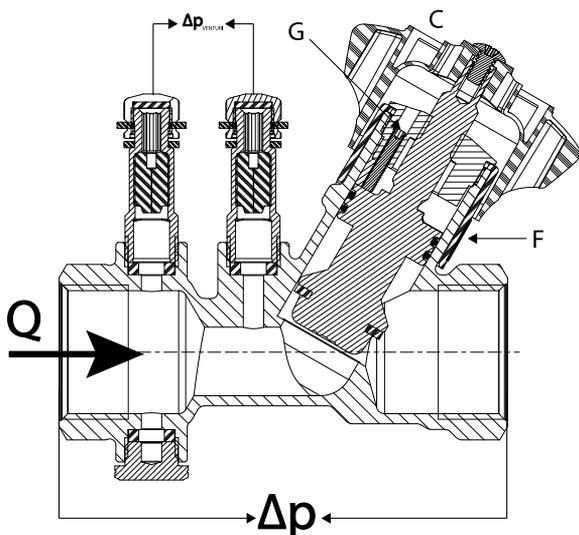
**Рисунок 4.** Клапан балансировочный статичный R206B продольное сечение. С – рукоятка, F – настроечная шкала, G – стопорный винт.
