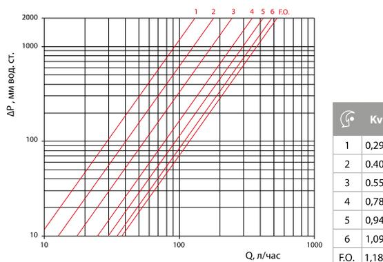
ΔT=2K для термостатического клапана, клапан двойной регулировки полностью открыт
