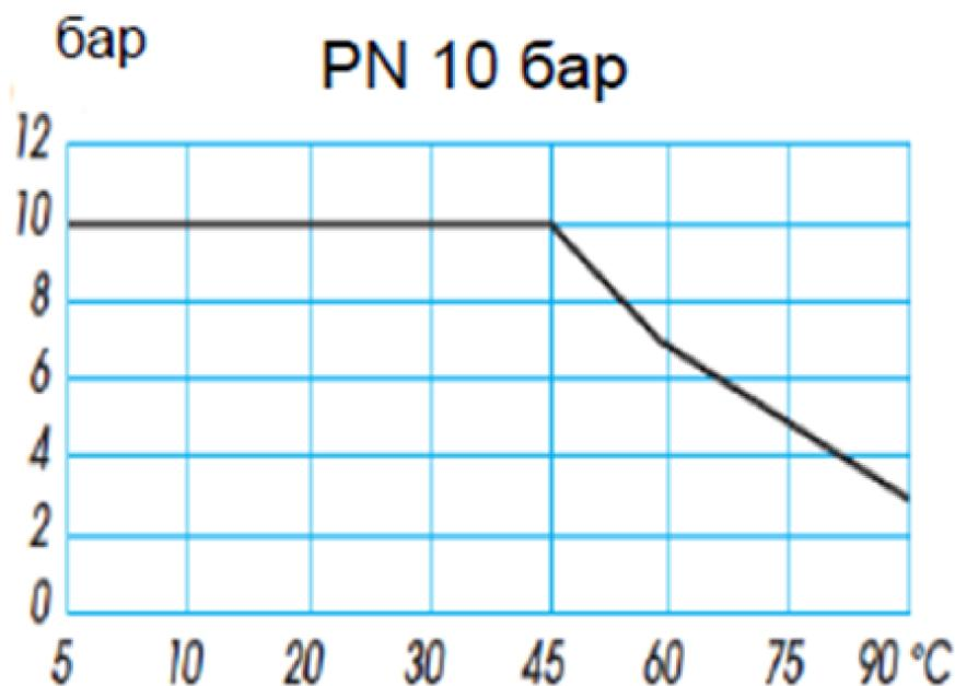
Зависимость рабочего давления от температуры перемещаемой среды
