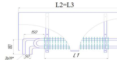
Рис. 2 Конвектор ТЗПО «Универсал НП ТБ-С»
