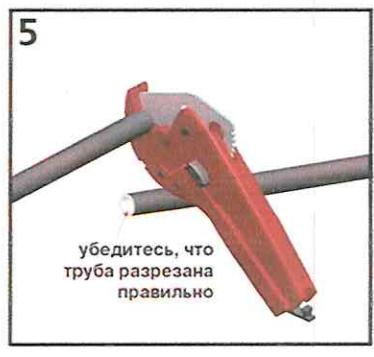
4.7. Порядок выполнения надвижного соединения с помощью ручного инструмента показан на рисунках 6÷16.
